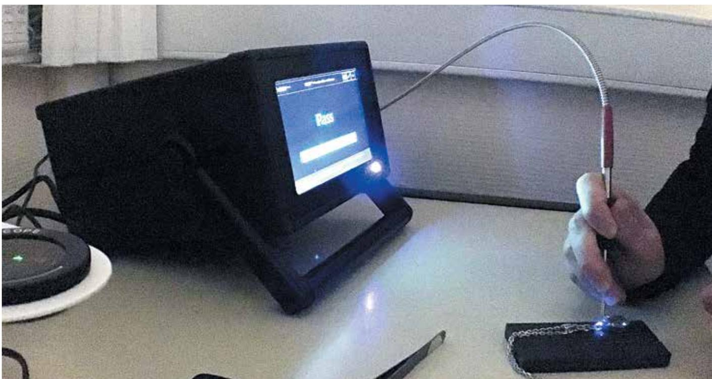
Фото 5. Анализ бриллиантов с помощью прибора EXA – The Natural Diamond Detector
