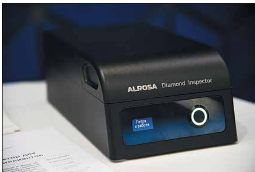
Фото 7. Скринер «ALROSA Diamond Inspector». Фотография ALROSA
